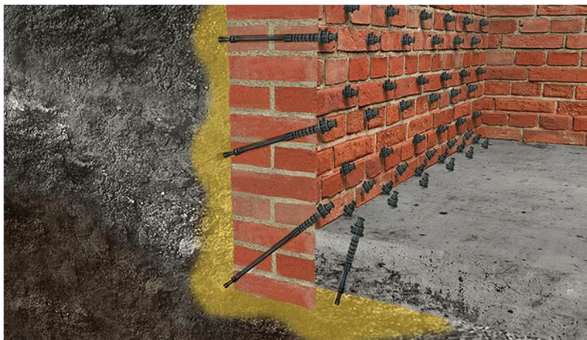
Рисунок 12. Создание противодиффузионного экрана.
